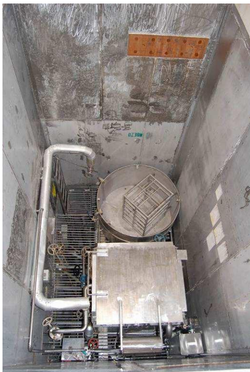
II.6 kép. A DZ30N-3 ultrahangos szennyezésmentesítő tartály és a DZ30N-8 elektrokémiai tartály
